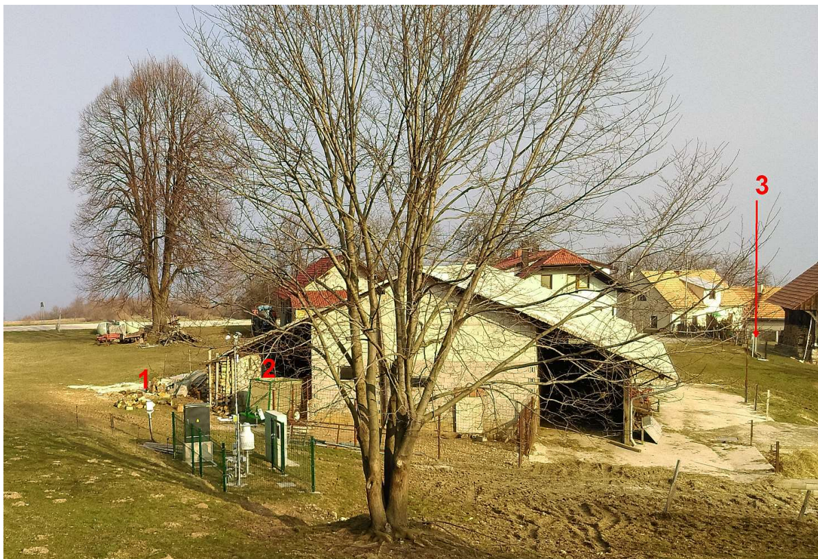
Slika 2. Samodejna in padavinska postaja ter elektronski zapisovalnik na Planini v Podbočju, marec 2017 (arhiv ARSO). S številko 1 je označen elektronski zapisovalnik, z 2 samodejna postaja in s 3 dežemer.
