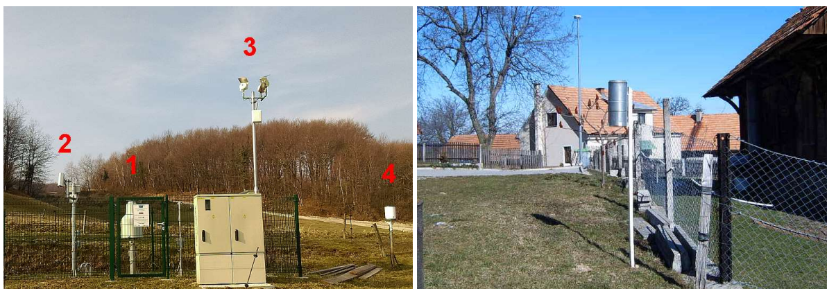
Slika 3. Samodejna postaja in elektronski zapisovalnik, marec 2017 (levo) in padavinska postaja, dežemer ali pluviometer, na Planini v Podbočju, marec 2009 (arhiv ARSO). Na levi sliki je z 1 označen tehtalni ombrometer, z 2 senzor za lasersko merjenje snežne odeje, s 3 kamere za trenutno vreme in s 4 elektronski zapisovalnik padavin.
